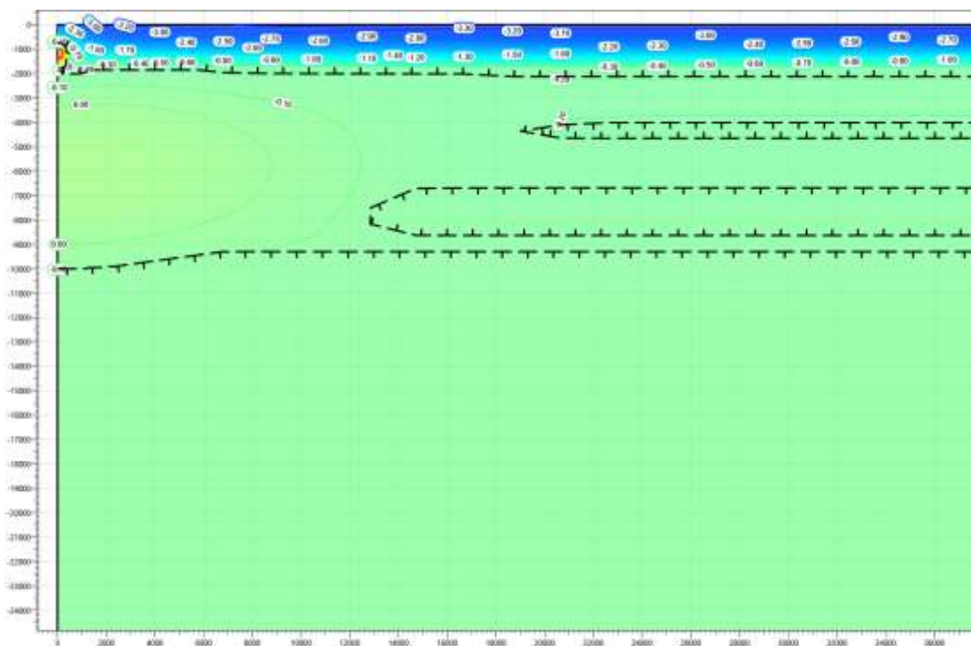
Рисунок В.9 – Температурное распределение в районе участка проектируемого газосборного трубопровода DN 300 от КП206-13 в районе ПК 34+00. Конец зимнего сезона десятый год эксплуатации.
