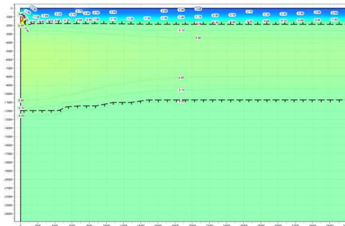
Рисунок В.51 – Температурное распределение в районе участка проектируемого газосборного трубопровода DN 400 от площадки узла приема СОД в районе ПК 175+00. Конец зимнего сезона десятый год эксплуатации.
