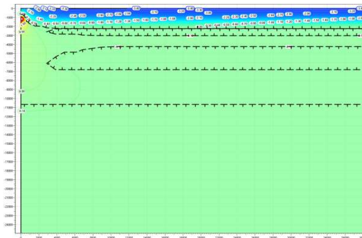
Рисунок В.21 – Температурное распределение в районе участка проектируемого газосборного трубопровода DN 300 от КП206-13 в районе ПК 37+00. Конец зимнего сезона пятый год эксплуатации.
