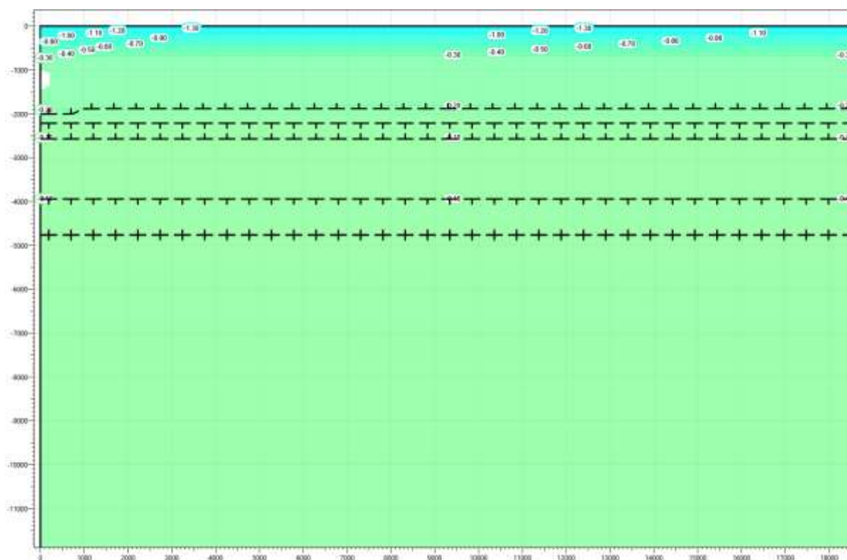
Рисунок В.29 – Температурное распределение в районе участка проектируемого газосборного трубопровода DN 400 от площадки узла приема СОД в районе ПК 169+00. Конец зимнего сезона первый год эксплуатации.
