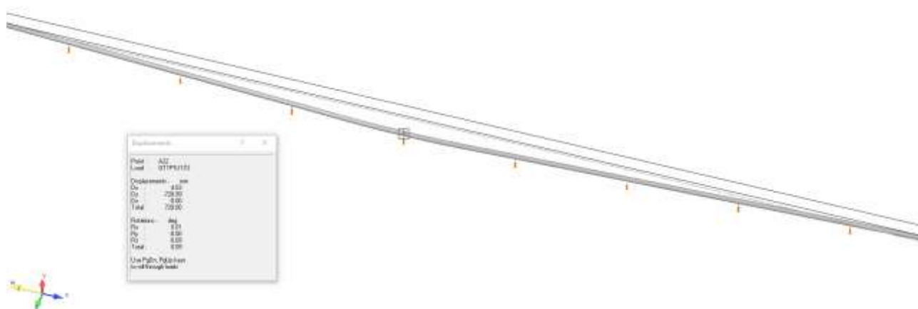
Рисунок 9 – Картина просадки в районе ПК205+00-ПК206+46,56 перед узлом приема СОД DN400
