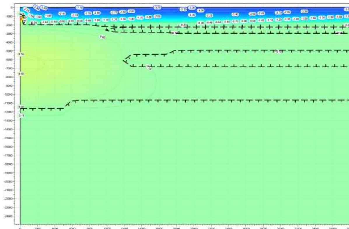
Рисунок В.23 – Температурное распределение в районе участка проектируемого газосборного трубопровода DN 300 от КП206-13 в районе ПК 37+00. Конец зимнего сезона десятый год эксплуатации.
