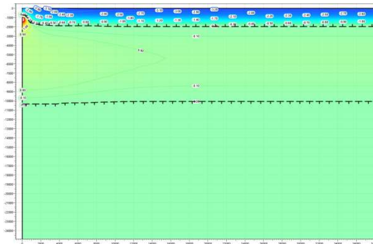
Рисунок В.47 – Температурное распределение в районе участка проектируемого газосборного трубопровода DN 400 от площадки узла приема СОД в районе ПК 175+00. Конец зимнего сезона третий год эксплуатации.
