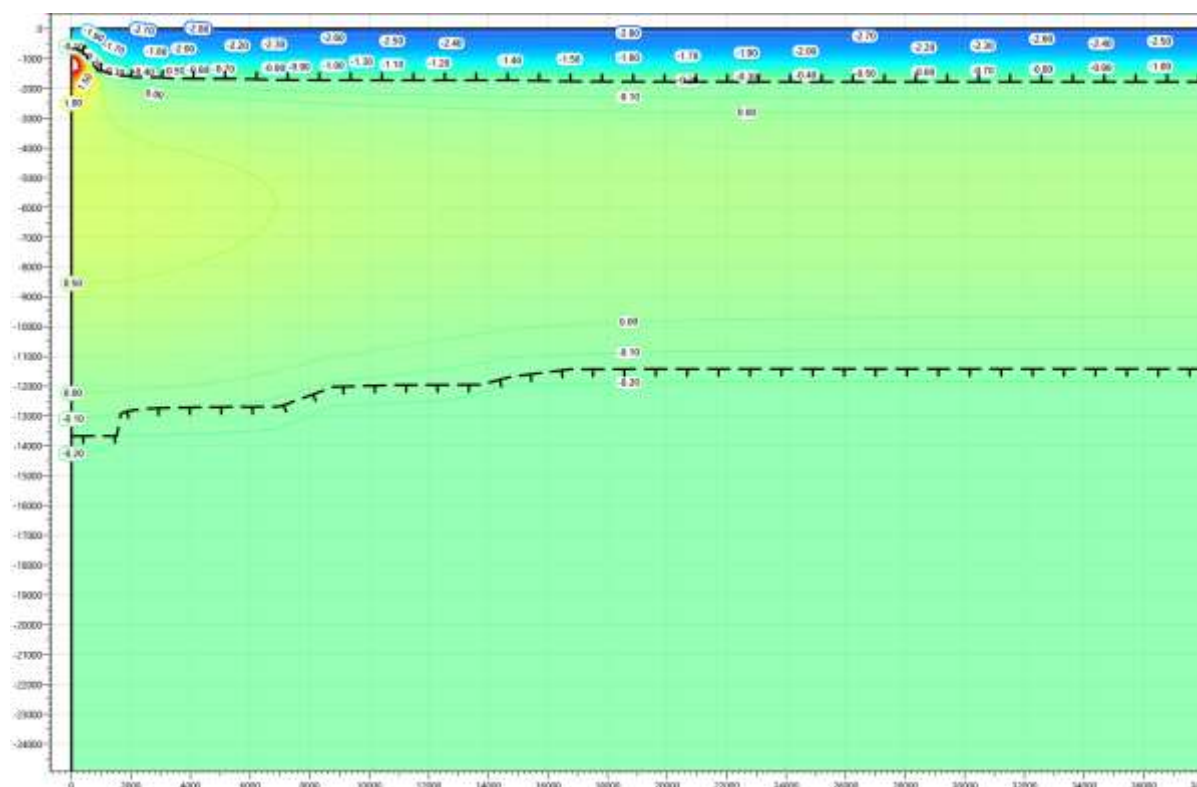
Рисунок В.53 – Температурное распределение в районе участка проектируемого газосборного трубопровода DN 400 от площадки узла приема СОД в районе ПК 175+00. Конец зимнего сезона пятнадцатый год эксплуатации.
