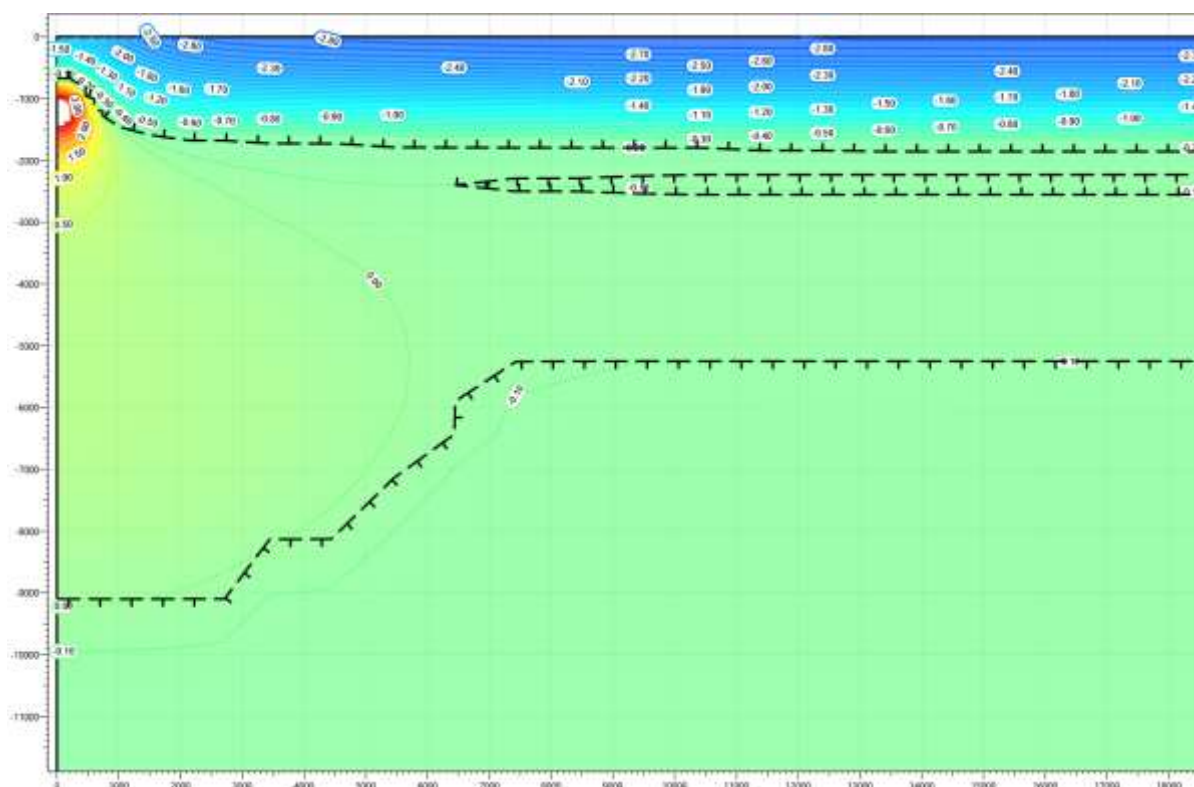
Рисунок В.41 – Температурное распределение в районе участка проектируемого газосборного трубопровода DN 400 от площадки узла приема СОД в районе ПК 169+00. Конец зимнего сезона двадцатый год эксплуатации.
