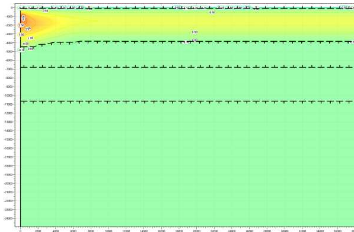
Рисунок В.18 – Температурное распределение в районе участка проектируемого газосборного трубопровода DN 300 от КП206-13 в районе ПК 37+00. Конец летнего сезона второй год эксплуатации.
