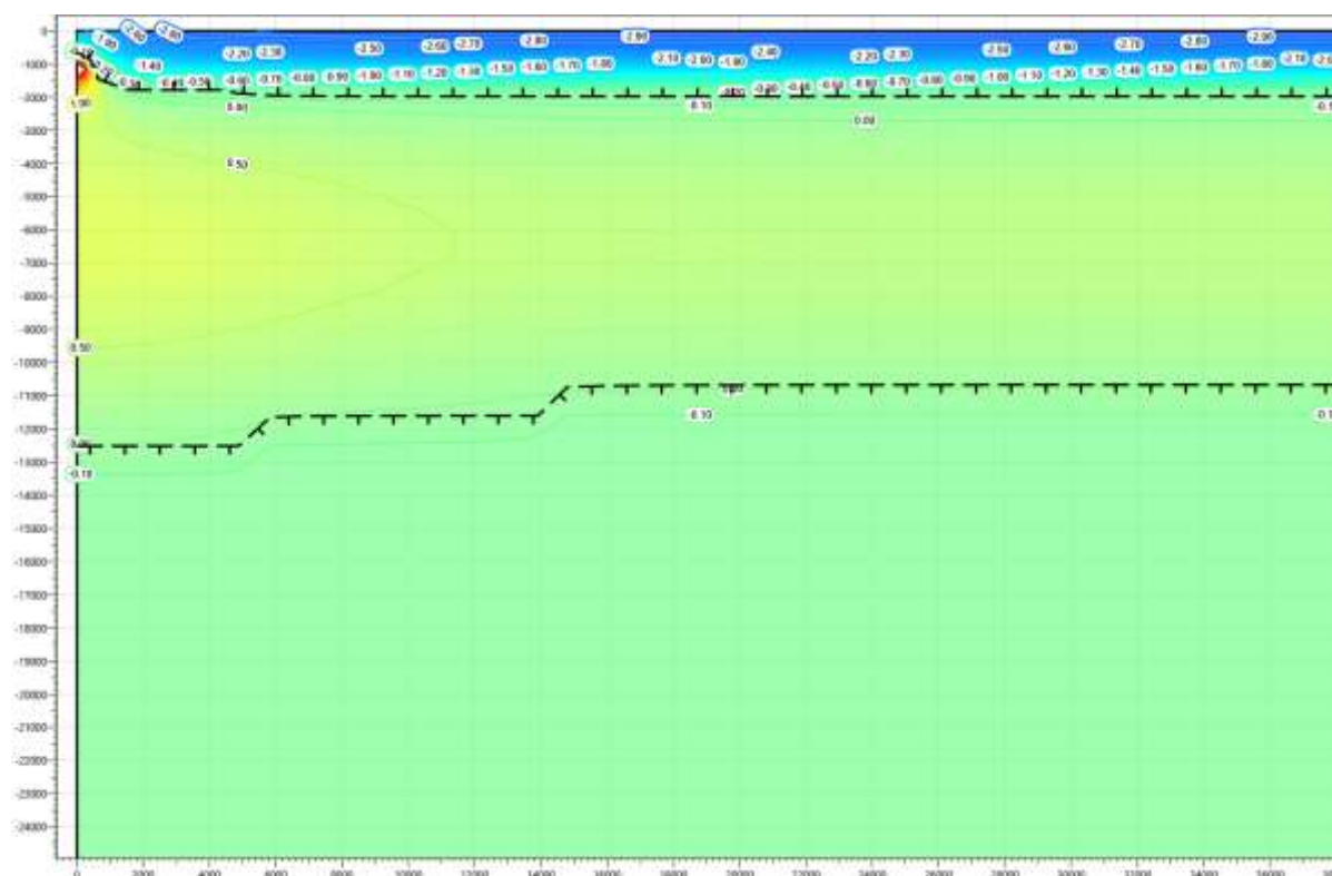
Рисунок В.25 – Температурное распределение в районе участка проектируемого газосборного трубопровода DN 300 от КП206-13 в районе ПК 37+00. Конец зимнего сезона пятнадцатый год эксплуатации.
