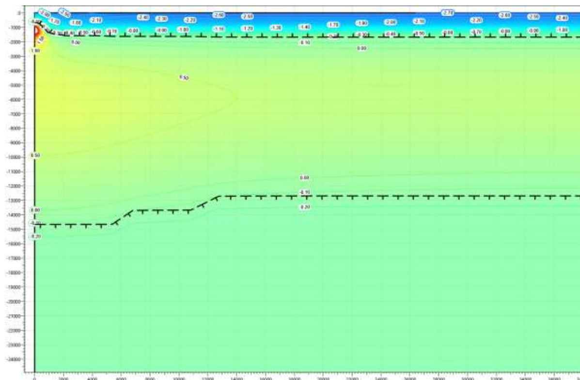
Рисунок В.55 – Температурное распределение в районе участка проектируемого газосборного трубопровода DN 400 от площадки узла приема СОД в районе ПК 175+00. Конец зимнего сезона двадцатый год эксплуатации.
