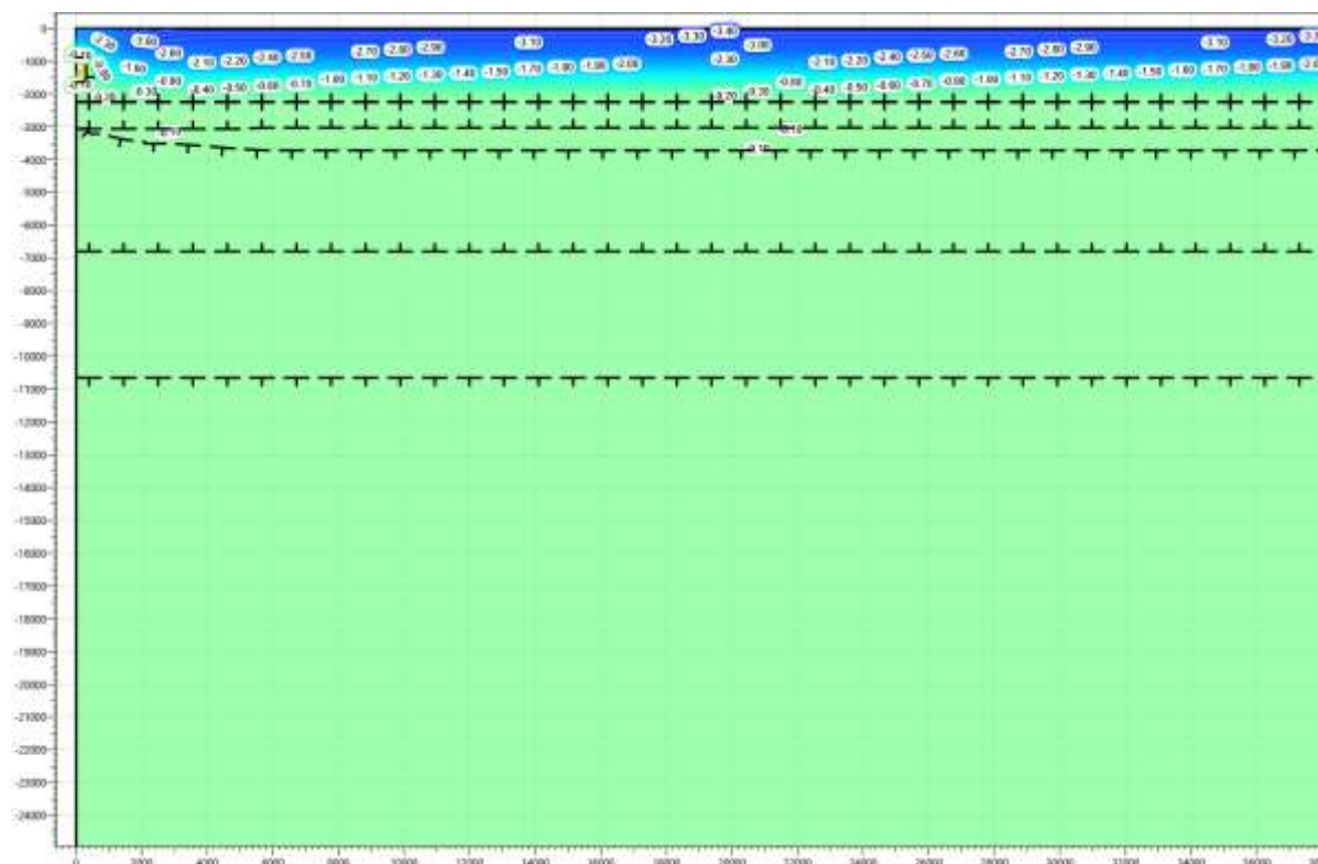
Рисунок В.17 – Температурное распределение в районе участка проектируемого газосборного трубопровода DN 300 от КП206-13 в районе ПК 37+00. Конец зимнего сезона второй год эксплуатации.
