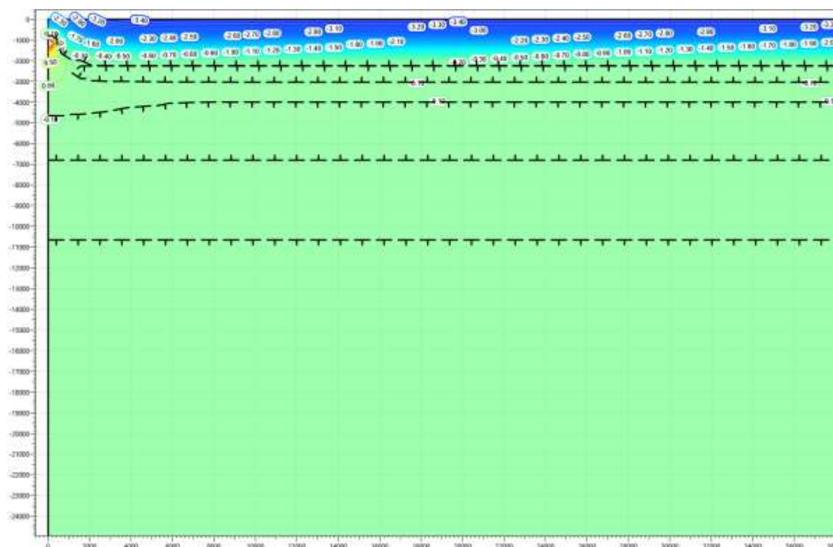
Рисунок В.19 – Температурное распределение в районе участка проектируемого газосборного трубопровода DN 300 от КП206-13 в районе ПК 37+00. Конец зимнего сезона третий год эксплуатации.
