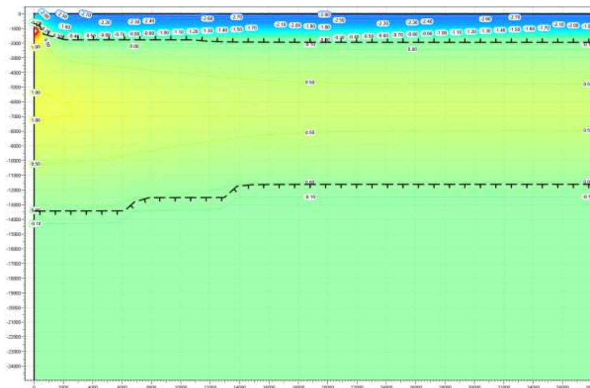
Рисунок В.27 – Температурное распределение в районе участка проектируемого газосборного трубопровода DN 300 от КП206-13 в районе ПК 37+00. Конец зимнего сезона двадцатый год эксплуатации.
